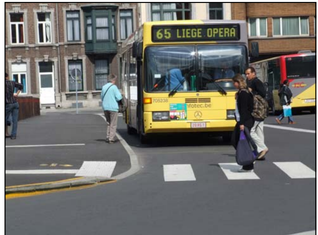
Liège-Guillemins : mauvais accostage © ACTP
