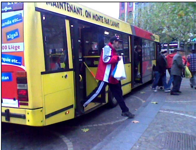
Liège, gare Léopold : les quais courbes et/ou partagés sont souvent responsables de mauvais accostages
