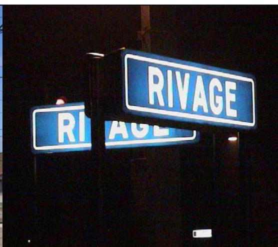
*A gauche, l'exemple à ne pas suivre : les panneaux ne sont pas disposés en oblique par rapport à la voie et sont tous dans le même alignement.
