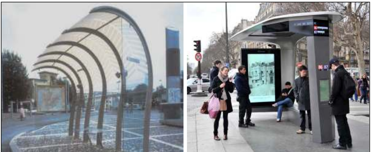
Deux exemples d'abribus particulièrement esthétiques mais qui remplissent très mal leur fonction première : offrir une protection à la clientèle (à gauche : Lyon, à droite : Paris).
