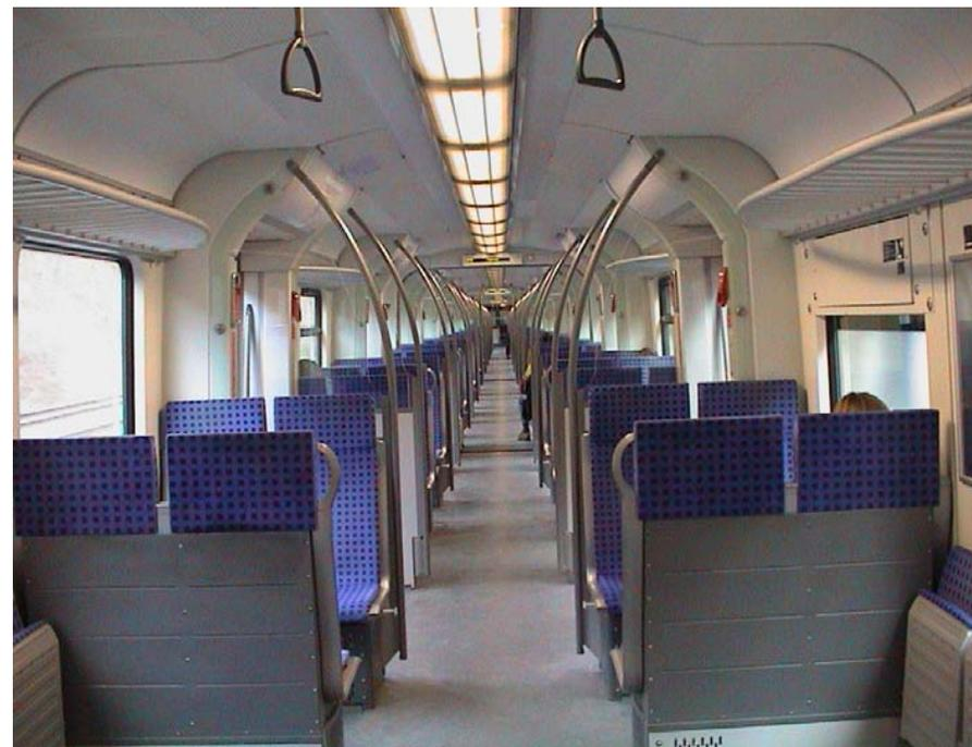
*Le plancher bas et l'intercirculation large permettent un accès aisé.*
