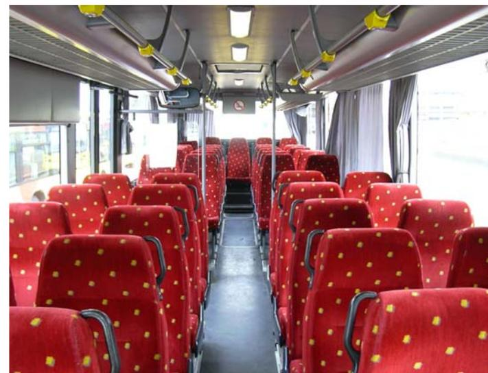
On regrettera l'absence de soute à bagages sur la version standard (une version baptisée Integro H, dotée d'un plancher plus haut, possède toutefois une soute permettant d'embarquer 6,6m<sup>3</sup> de bagages). La disposition des boutons de demande d'arrêt, en hauteur sur les mains courantes, laisse également à désirer.
