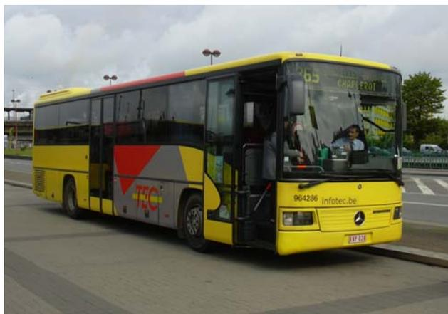
Lancé en 1997, l'Integro est spécialement conçu pour les trajets interurbains. Il ressemble à un autocar qui serait équipé d'un afficheur de destination et de mains courantes le long des porte-bagages.
