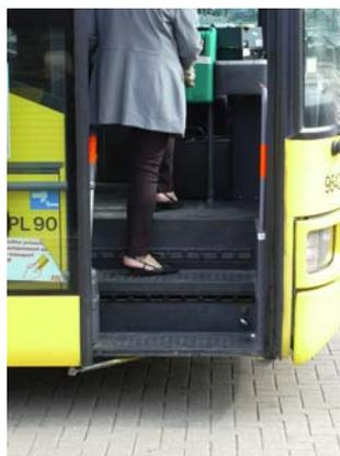
*Les bus construits sur un châssis de car présentent un emmarchement important. Les embarquements étant limités sur les lignes longues distances, l'accessibilité n'est pas une priorité des constructeurs sur ce genre de modèle interurbain.*
