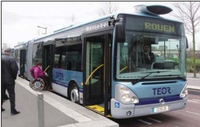
A Rouen, trois lignes de bus sont exploitées par des véhicules à guidage optique facilitant l'accostage pour un embarquement de plain-pied.
