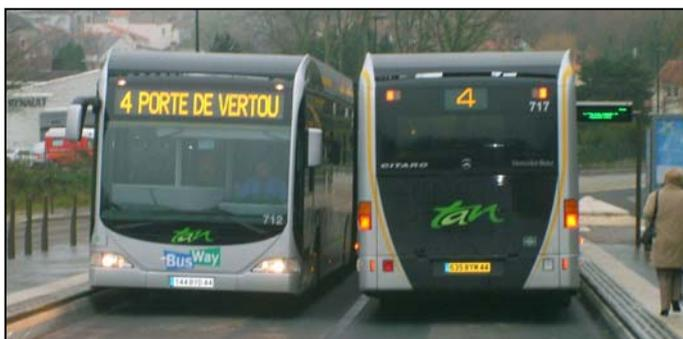
Le Busway de Nantes est un nouveau concept de transport collectif : des bus articulés à haut niveau de service et fonctionnant au gaz circulent en site propre intégral sur les 7km que compte la ligne.
