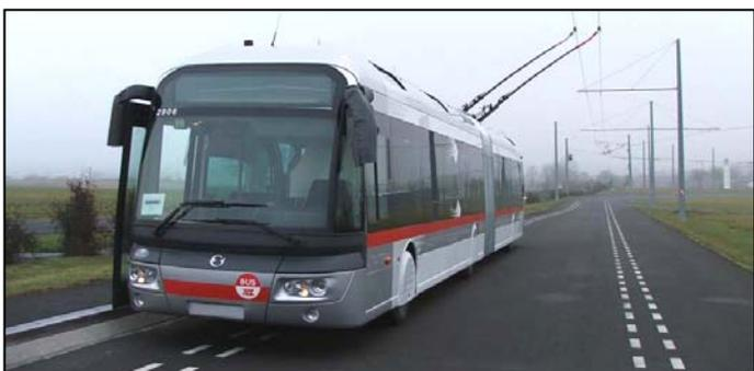
Développé par Irisbus, le Trolleybus Cristalis dispose d'un guidage optique : une caméra installée à l'avant de la rame repère un marquage peint sur la chaussée.
