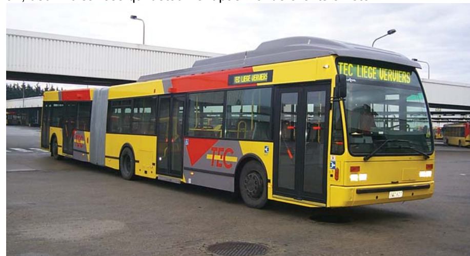
Le nouveau bus articulé avec, sur le toit, le groupe de conditionnement d'air
