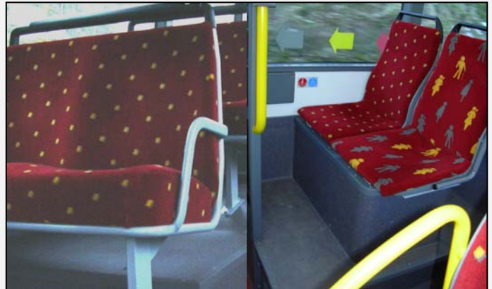
Comparaison de l'épaisseur et du devers des sièges de deux bus récents. La différence de confort est évidente. A noter que le siège de droite, dédié aux handicapés, est placé sur une estrade.
