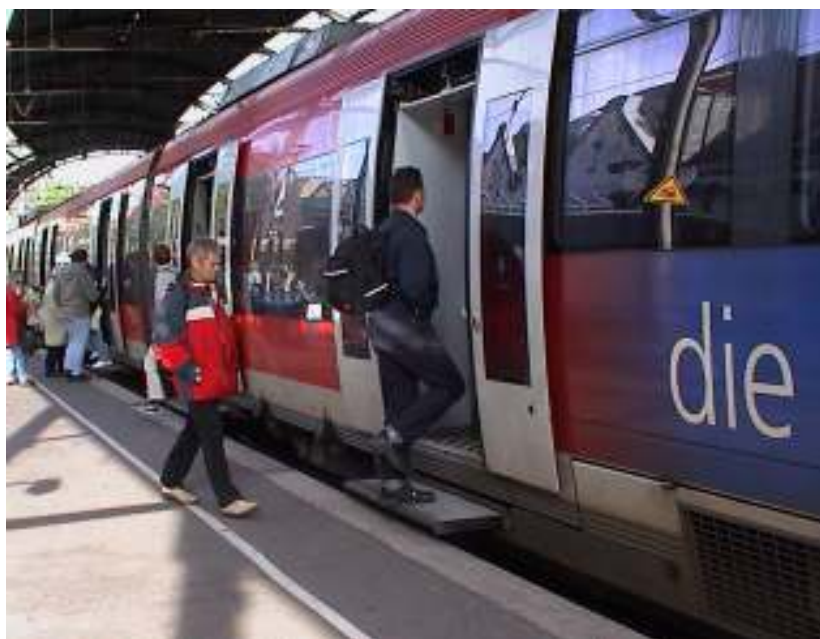
Matériel Bombardier (TALENT) accosté à un quai bas (Aachen Hbf) Remarquer le Marche-pied rétractable qui permet d'atteindre facilement le plancher à 750mm. Ce matériel diffusé à des centaines d'exemplaires roule dans une vingtaine de pays, sur 3 continents, en différentes versions : diesel, électrique et même en pendulaire.
