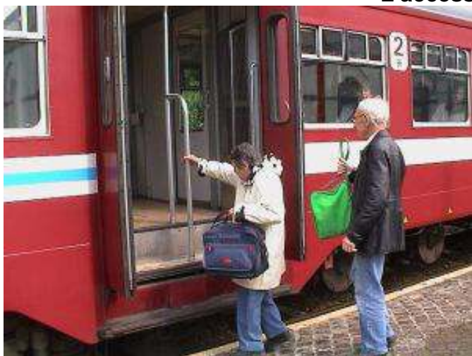
Emmarchement du matériel actuellement en service sur la ligne 43. A noter, que sur les rames « rénovées » la rampe centrale a été supprimée.
