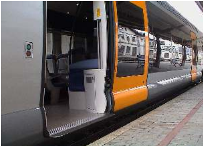
Exemple de matériel adapté aux dessertes régionales : matériel Alstom au Luxembourg Ici en face d'un quai bas (Bettembourg) Accosté à un quai de 500 mm, Ce matériel permet un embarquement de plain-pied
