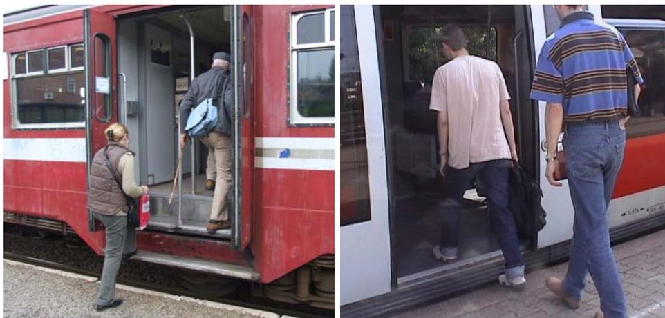
Comparaison d'un embarquement à bord d'un train local à la SNCB et à la DB (Allemagne). Le retard de la SNCB est flagrant (matériel roulant, accès de plain-pied, hauteur et revêtement de quais, ...) © ACTP
