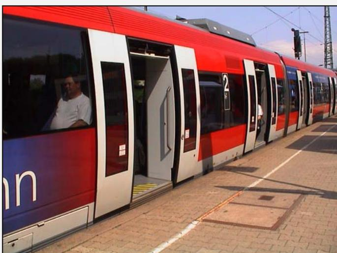
Le Talent de Bombardier dispose de larges portes bien réparties, à doubles battants et d'un accès aisé. L'embarquement se fait ainsi rapidement pour une diminution du temps d'immobilisation aux arrêts
