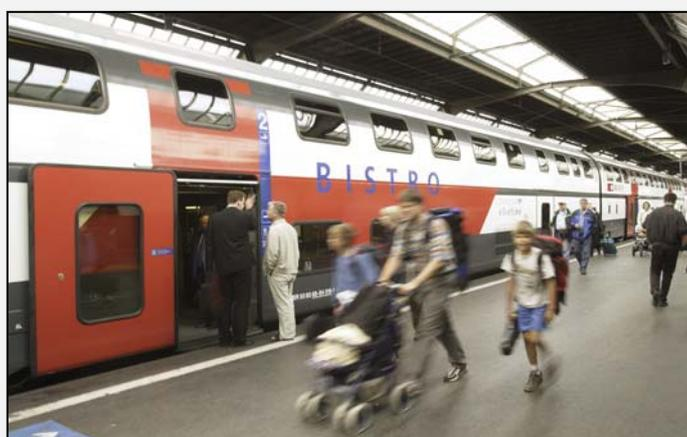
L'IC2000 des CFF est un matériel double étage qui présente la particularité d'avoir deux larges portes entre les bogies, ce qui permet un embarquement de plain-pied face à un quai haut. De plus, l'intercirculation se fait au niveau supérieur : toute la rame peut ainsi être parcourue de plain-pied. Près de 200 trains de ce type circulent chaque jour en Suisse et desservent 64 gares équipées de quais hauts où les voyageurs peuvent embarquer en toute autonomie
