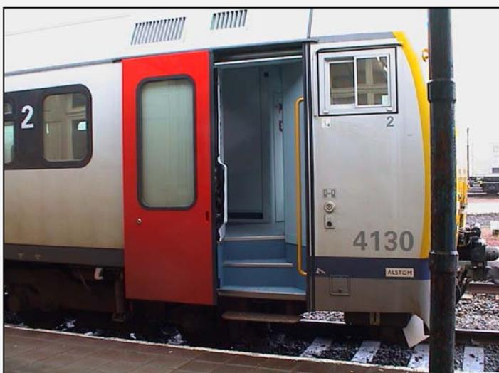
Avec des portes étroites aux extrémités et un emmarchement important, le matériel roulant de la SNCB est loin d'être un modèle d'accessibilité
