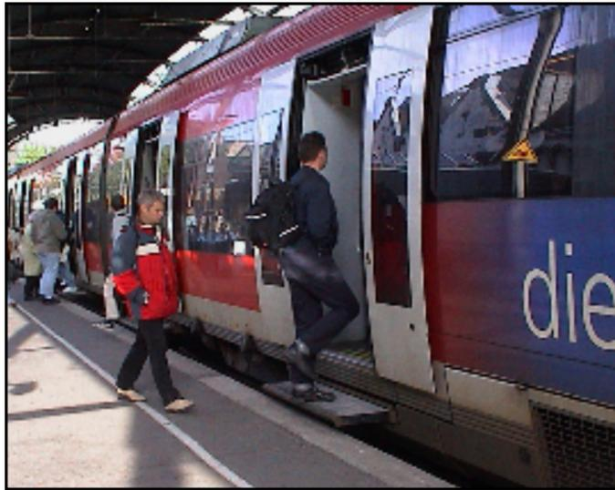
*Le Talent de Bombardier accosté à un quai bas (Aachen Hbf). On remarquera le marche-pied rétractable qui permet d'atteindre facilement le plancher à 750mm. Ce matériel diffusé à des centaines d'exemplaires roule dans une vingtaine de pays, sur trois continents, en différentes versions : diesel, électrique et même en pendulaire.*
