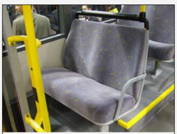
Les sièges du VanHool A 360 en livrée De Lijn. Bonne épaisseur et dévers permettant de maintenir le voyageur au fond : un exemple à suivre !
