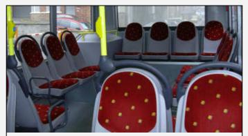
Ces cousins des sièges sont tout-à-fait symboliques : ils ne permettent pas d'effacer les chocs verticaux. Par ailleurs, les sièges disposés transversalement sont particulièrement inconfortables en cas de freinages et d'accélérations.
