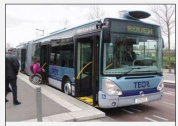
Les Irisbus Citelis du TEOR de Rouen sont équipés d'un système de guidage optique pour un accostage optimal autorisant un accès de plain-pied et l'autonomie.
