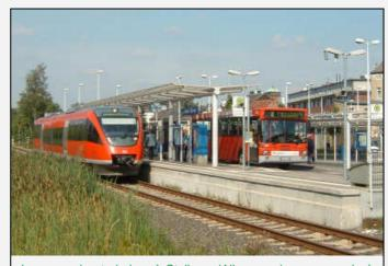
La connexion train-bus à Stolberg (Allemagne) : un exemple à suivre (distance minimale, couverture des quais, accès de plain-pied, ...). © ACTP
