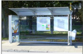
De nombreux abribus n'offrent pas des parois latérales allant du sol à la toiture. Dans bien des cas, le nom de l'arrêt n'est pas visible depuis l'intérieur des véhicules et les sièges sont souvent mal disposés (devant les horaires ou le plan du réseau). © ACTP
