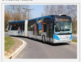
Maubeuge. Le BHNS de la ligne 51. Il est assuré par des Criolis (d'IVECO) Ce matériel peut être équipé du guidage optique. De nombreux sièges du tracteur sont sur estrade (dont un pour pmr!)
