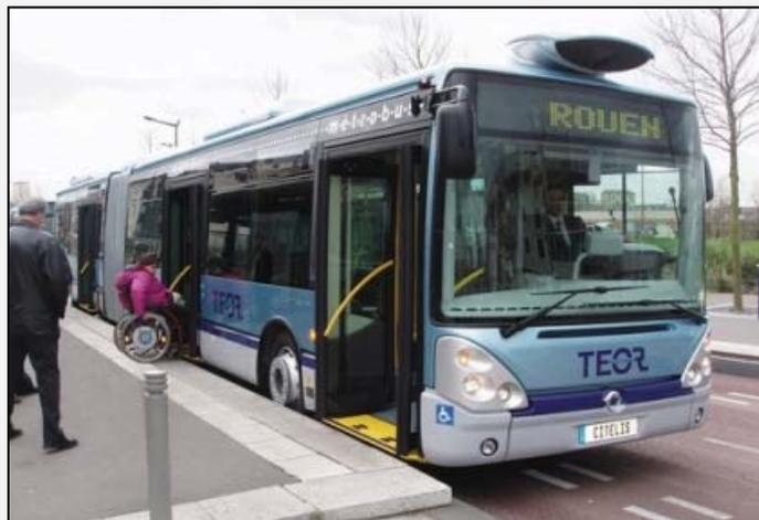
Les Irisbus Citelis du TEOR de Rouen sont équipés d'un système de guidage optique pour un accostage optimal garantissant un accès de plain-pied. © ACTP
