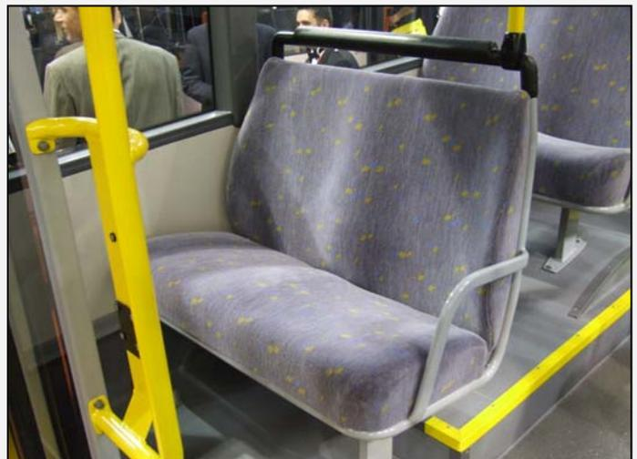
Les sièges du VanHool New A 360 en livrée De Lijn. Bonne épaisseur et dévers permettant de maintenir le voyageur au fond : un exemple à suivre !
