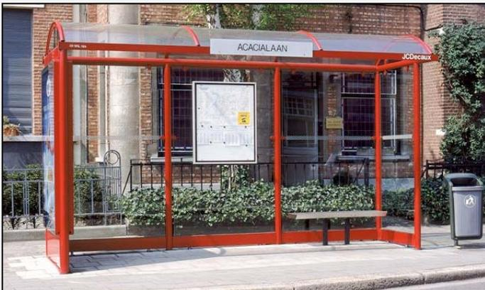
Cet abri dispose de bonnes parois latérales assurant une protection contre les pluies obliques. Le nom de l'arrêt figure bien en évidence et le siège est judicieusement décalé par rapport à la valve d'information.
