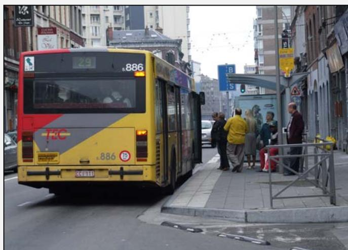
La contre-alvéole permet un bon accostage mais peut engendrer des encombrements (le bus bloquant une bande de circulation).
