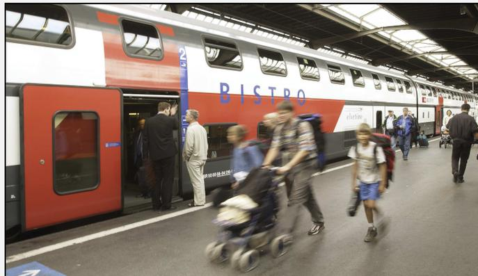
L'IC2000 des CFF est un matériel double étage qui présente la particularité d'avoir deux larges portes entre les bogies, ce qui permet un embarquement de plain-pied face à un quai haut. De plus, l'intercirculation se fait au niveau supérieur : toute la rame peut ainsi être parcourue de plain-pied. © CFF
