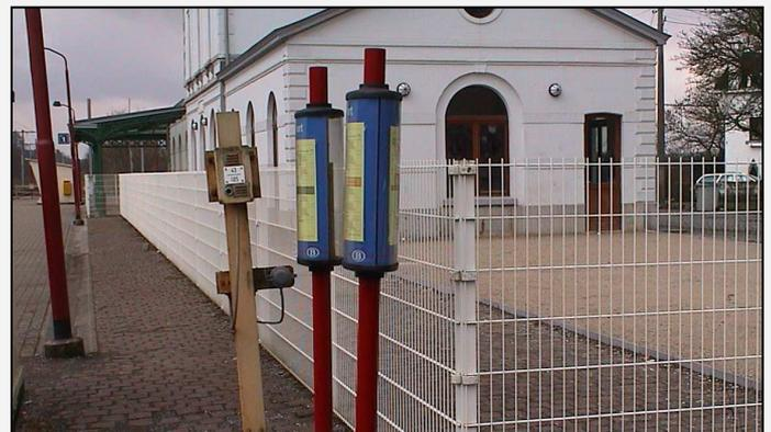
Ci-dessus : le verso de ces tambours horaires, placés devant une clôture, est illisible. N'étant pas rétro-éclairé, sa disposition par rapport à l'éclairage est importante mais elle laisse à désirer. La pluie ou la condensation rend par ailleurs sa lecture difficile.
