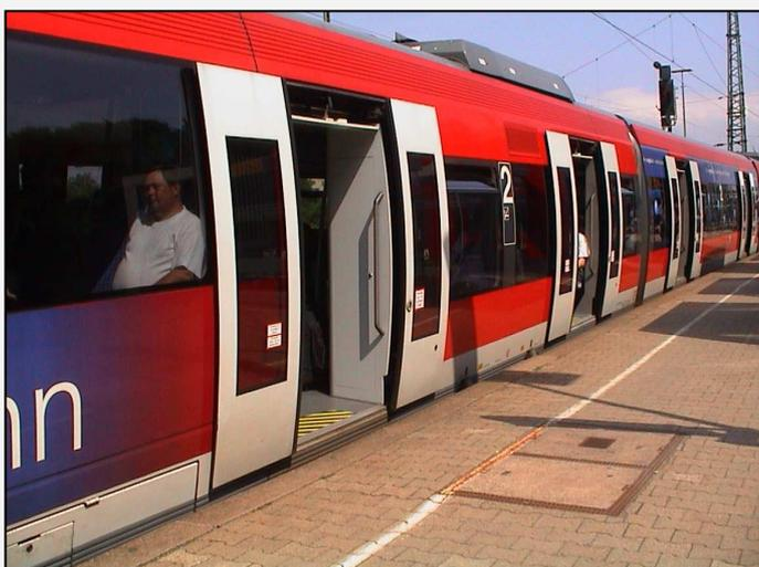
Le Talent de Bombardier dispose de larges portes bien réparties, à doubles battants et d'un accès aisé. L'embarquement se fait ainsi rapidement pour une diminution du temps d'immobilisation aux arrêts. © ACTP
