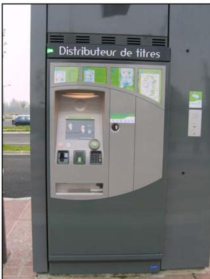
*Tram de Valenciennes : distributeur automatique de titres de transport. La navigation à l'aide d'une molette est plus commode qu'avec un écran tactile.* © ACTP
