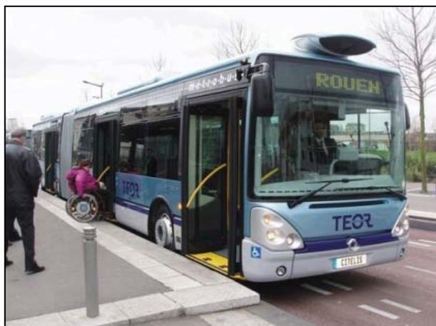
A Rouen, trois lignes de bus baptisées TEOR sont exploitées par des véhicules équipés d'un dispositif de guidage optique visant à optimiser l'accessibilité en station. **Ce système assure la précision et surtout la régularité de l'accostage.**
