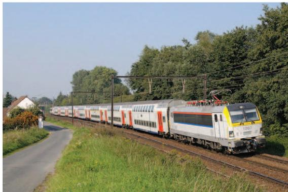
Les voitures à double étage ont permis d'augmenter la capacité et le confort sur plusieurs relations très fréquentées, comme ici l'IR Binche - Louvain-la-Neuve, sur la ligne 117. (© Corentin Cauwelier)
